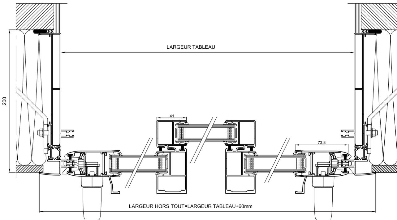
Coulissant alignés 3 vantaux/2rails Performance équipement A : Isolation de 100 avec appui standard SVR
