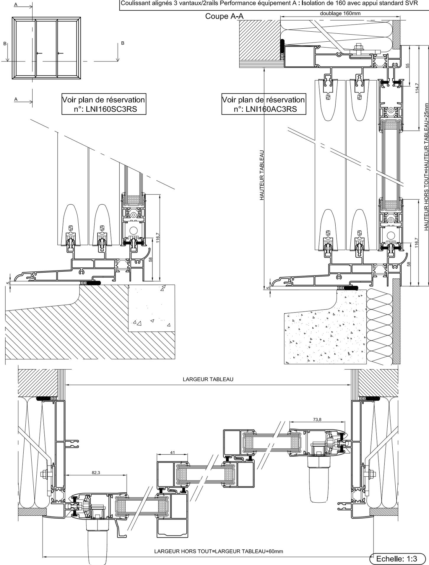
Coulissant alignés 3 vantaux/2rails Performance équipement A :Isolation de 160 avec appui std et encastrés+volet roulant intérieur
